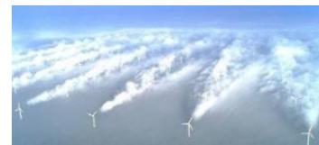
Cet effet de sillage a conduit GDF Suez, en 2015, à établir que les éoliennes situées, dans le sens du vent en deuxième ligne devaient être à une distance de 7 fois le diamètre du rotor et perpendiculairement au vent dominant à 2 ou 3 fois le diamètre du rotor. En 2015 le diamètre des rotors n'excédait pas 100 m (pales de 50 m) donc il était concevable qu'une distance de 500 m ne perturberait pas les habitants.
